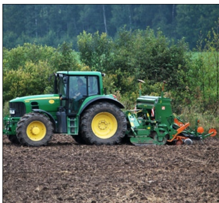
20., 21. attēls. Traktora trokšņa līmenis ir atkarīgs no tā, kādi agregāti tam ir piestiprināti
