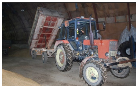
11. attēls. Nenostiprināta traktora piekabe ar kravu var radīt nelaimes gadījuma risku
