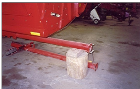
12. attēls. Nav pieļaujama lauksaimniecības mašīnu balstīšana uz nepiemērotiem atbalstiem, jo tas var beigties ar smagiem nelaimes gadījumiem
